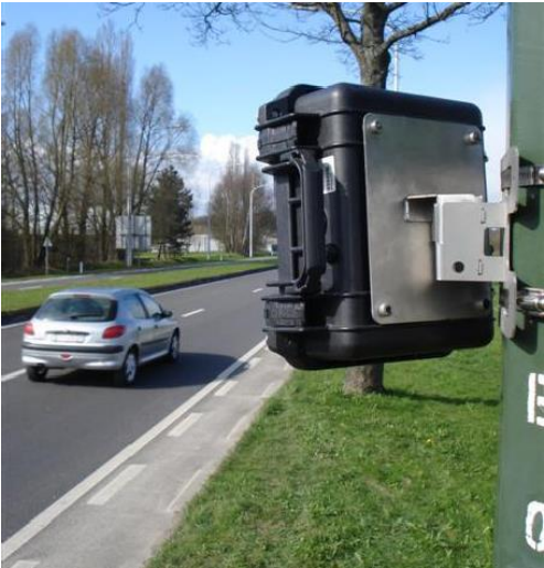
Figura 7: Esempio strumentazione radar Icoms TMS-SA4
