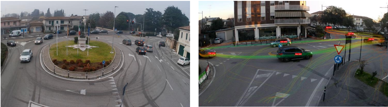
Figura 12: rilevamento manovre intersezione con telecamera digitale
