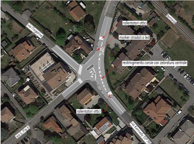
Figura 41: Messa in sicurezza intersezione tra via San Pio X, via f.lli Kennedy e via Ongarine (int. 7-C)
