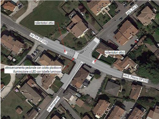
Figura 40: Sistemazione intersezione tra via S. Pio X e via Toti (SP 100) (int. 7-A)
