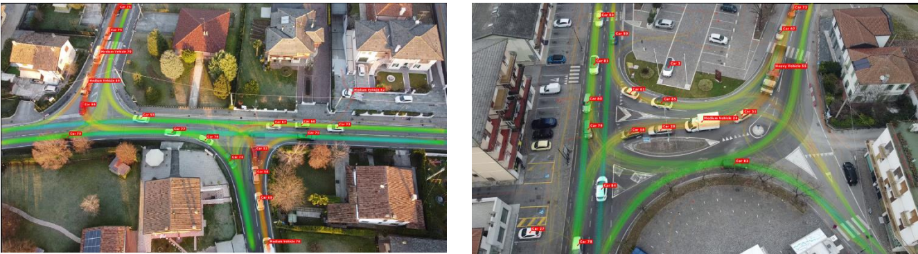
Figura 11. rilievo manovre intersezione tramite riprese aeree con drone
